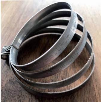
In den vier Ringen ist eingepreßt: Durchmesser xx mm oder Umfang xx mm usw.
